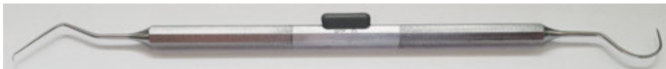
Fig. 1 Un tag RFID collé sur un instrument individuel
