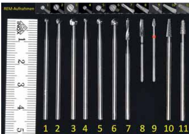
Abb. 1 Übersicht und REM-Aufnahmen der untersuchten rotierenden Hartmetallfräsen (Nr. 1–10) und des Referenzschleifkörpers (Nr. 11)
