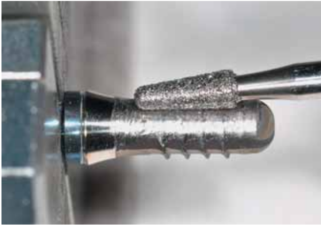
Abb. 3 Bearbeitung eines Implantates mit dem Referenzschleifkörper Nr. 11
