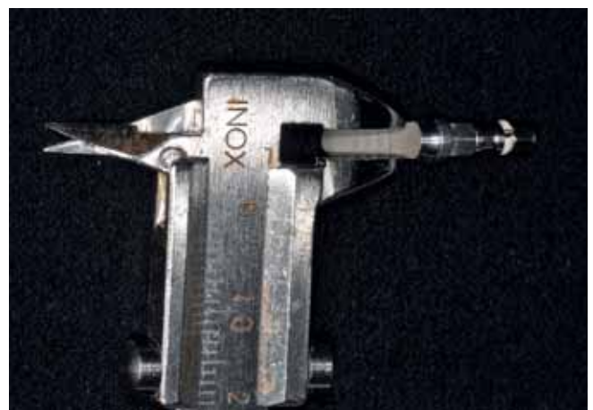
Abb. 2 Markierung der definierten Implantatoberfläche mit Schublehre
