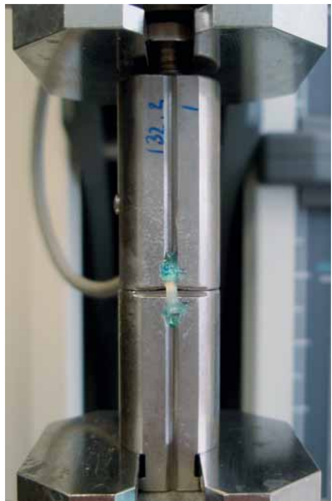
Abb. 2 Mikrozugprüfung, wobei das Dentin-Kompositstäbchen mit Sekundenkleber auf die Prüfhalterung geklebt wird.
