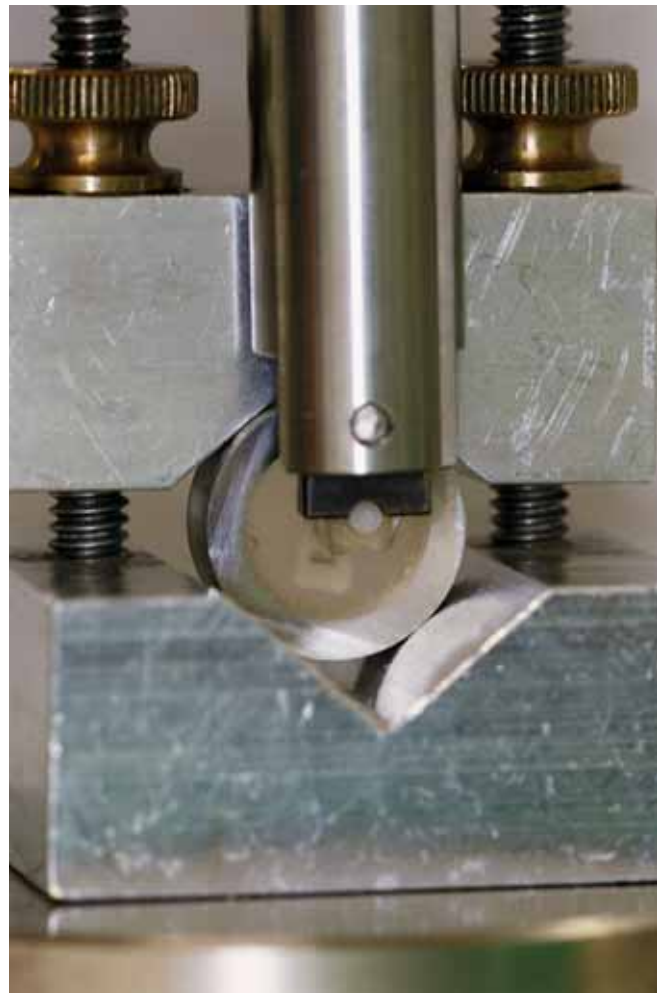
Abb. 1b Die Prüfhalterung umfasst den Kompositzylinder und schert ihn ab. Die Universalprüfmaschine erkennt den Bruch und ermittelt dadurch die Haftkraft.
