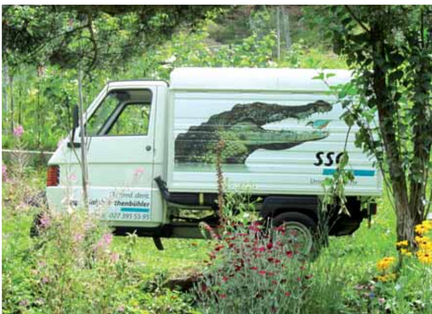
Die brandneue Biene als SSO-Werbeträger mit zwei Scheinwerfern, echtem Lenkrad statt Lenkstange, Stockschialtung, Kastenwagen und weisse Farbe.
