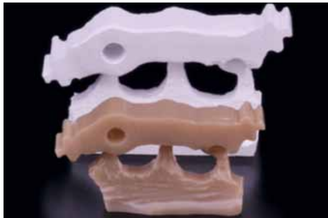
Abb. 13 Zirconasteg im Rohzustand vor (oben) und nach (unten) Sinterung – Darstellung des Grössenunterschieds basierend auf einer Sinterschrumpfung von 20%
