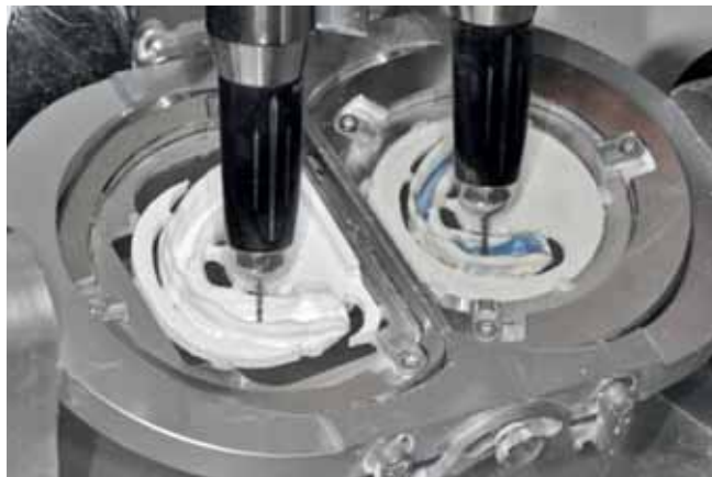
Abb. 16a Manuelle Kopierfräsung (links: Fräseinheit und Rohling, rechts: Abtasteinheit und Prothesenmodell)
