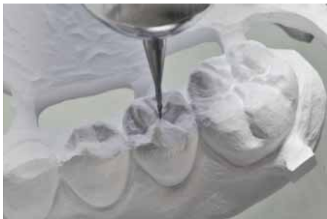
Abb. 16b Okklusionsgestaltung beim Kopierfräsen mit dem Zirkograf
