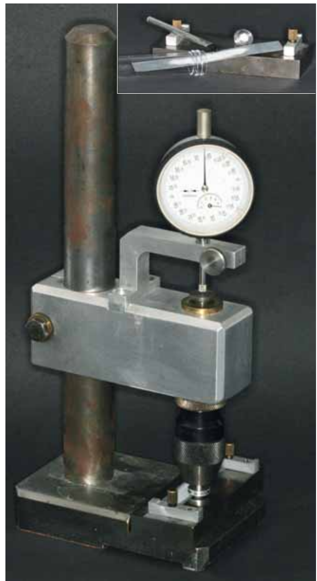
Abb. 1 Grosses Bild: Individuell hergestellte Vorrichtung zur kontrollierten Abrasion von Zahnsubstanzproben. Kleines Bild: Abrasionsschlitten mit einer im Halter fixierten Probe sowie ein Schleifpapierstreifen mit abadiertem Schmelzpulver.
