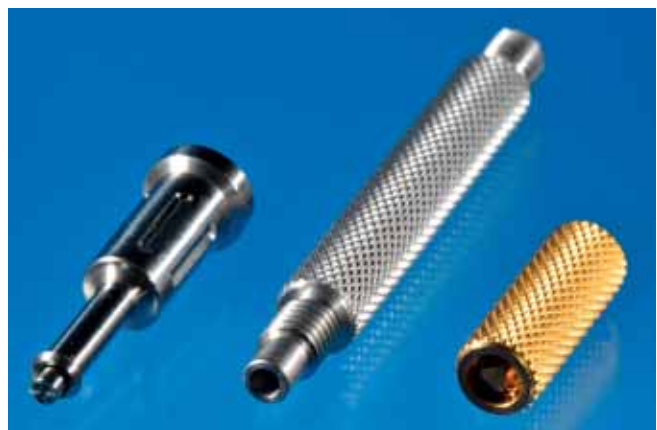
Abb. 11 Locator® Core Tool, bestehend aus drei Teilen: der Spitze zum Entfernen von Inserts aus den Matrizengehäusen, dem Mittelteil zum Einsetzen eines neuen Inserts sowie dem goldfarbenen Teil zum Eindrehen des Locator® Abutments.
