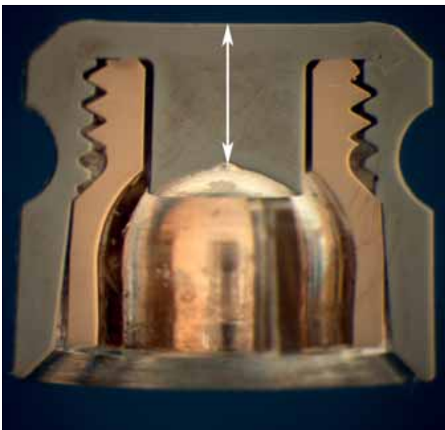
Abb. 2 Querschnitt durch eine Dalbo®-Plus-Matrize, bestehend aus einem Titangehäuse sowie einem Lamellen-Retentionseinsatz aus einer Goldlegierung. Zentral (weisser Pfeil) ist das Titangehäuse 1,5 mm hoch.
