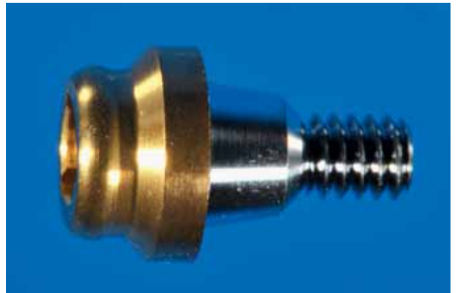
Abb. 8 Locator® Abutment, hier für ein Straumann-Standard-Implantat, mit einem ringförmigen Retentionsanteil, einer transmukosalen Manschette sowie einem Schraubenabschnitt. Der Retentionsanteil und die Manschette besitzen eine goldfarbene TiN-Beschichtung.
