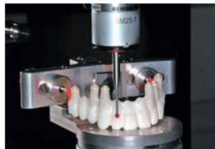
Abb. 9b Das Gerüst wird zuerst von basal und sekundär von okklusal mechanisch abgetastet.
