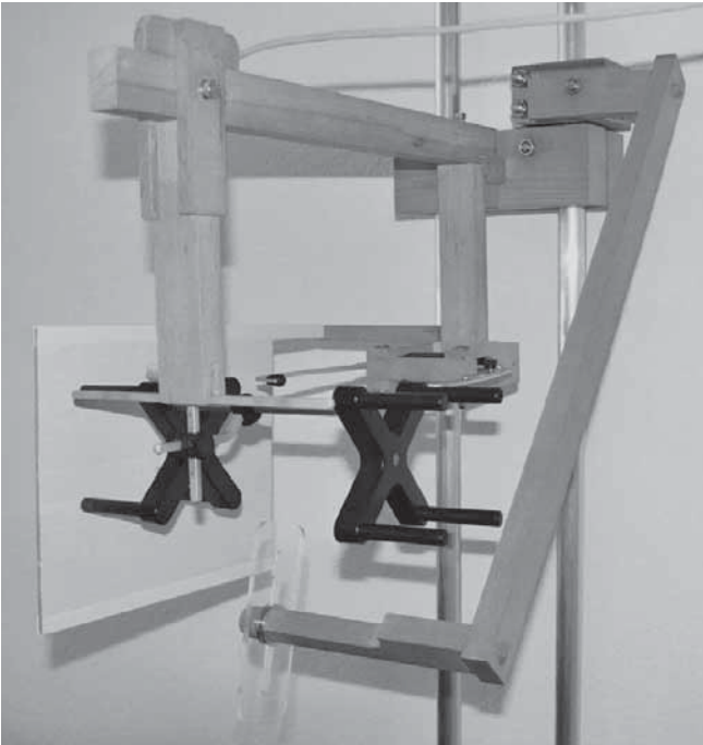
Abb. 2 Nachgebauter Kephalostat mit der Kinnstütze als zusätzliches stabilisierendes Element
