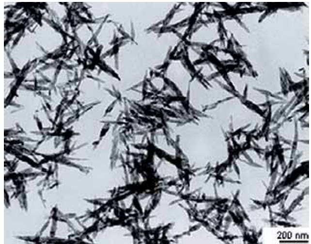
Abb. 1 Nanokristalle des phasenreinen, vollsynthetischen, anorganischen Hydroxylapatit-Knochenersatzmaterials Ostim® (Transmissionselektronenmikroskopische Aufnahme [TEM])
