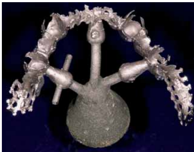
Abb. 23 Ausgebetteter Guss des Gerüsts vor der Ausarbeitung.
