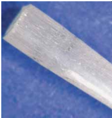
Abb. 3 Lichtmikroskopische Aufnahme von DT Light Post® nach dem Abzugsvorgang: keine Kompositreste auf der Verbundfläche
