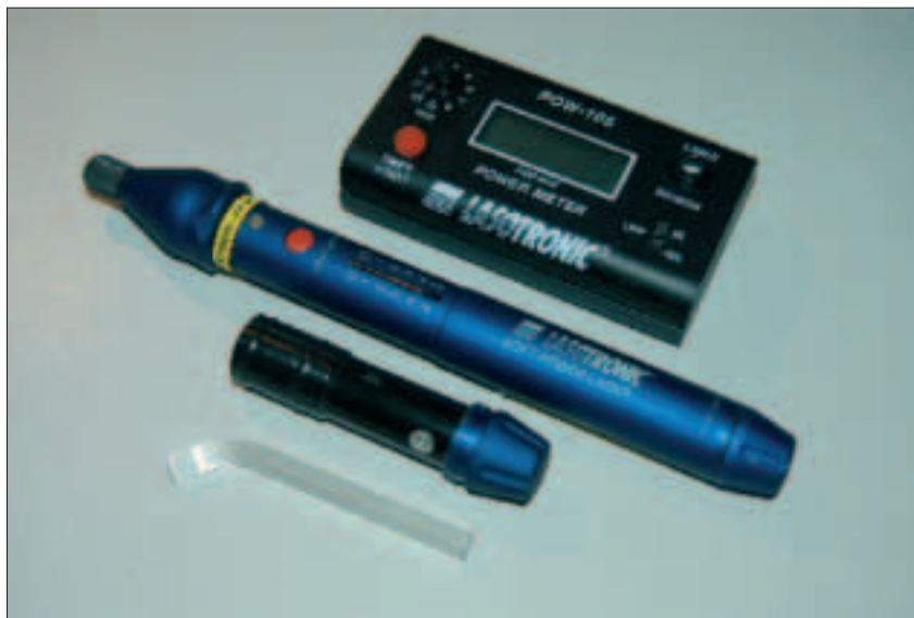
Abb. 4 Ein Softlasergerät mit Glasspitze für den oralen Bereich, Akku und Energiemessgerät
