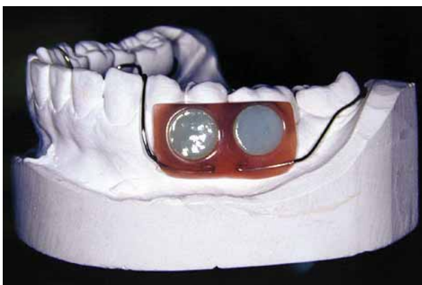
Abb. 2 Probenträger mit eingepassten Empressproben, Ansicht von bukkal Fig. 2 Porte-échantillon après adaptation des deux disques-échantillons en céramique Empress; vue vestibulaire
