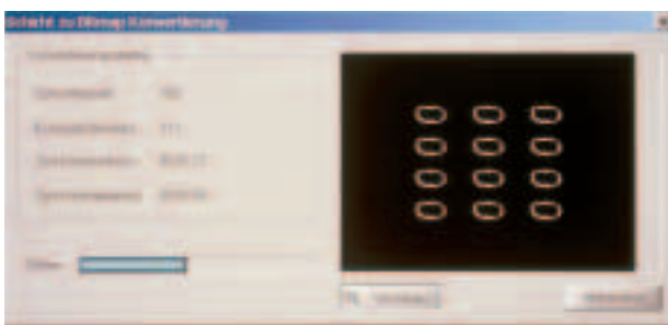
Abb. 12 Die 3D-Volumendaten der Kronen werden in Schichtdaten für die einzelnen Belichtungsschritte (Schichten) umgewandelt. Diese Schichtdaten werden in ein Belichtungsbild umgesetzt und auf den Boden des Flüssigkeitsbehälters projiziert.
