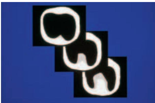
Abb. 13 Darstellung einzelner Schichten einer Krone als Belichtungsmasken.
