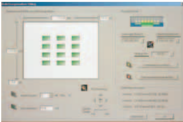
Abb. 11 Mit der Anlagenssoftware (Windows-Oberfläche) werden die einzelnen Teile auf der Bauplattform der Perfactory® verteilt. Parameter, wie Lage der Stütze und Dichte der Objekte, werden überwacht und ggf. korrigiert.
