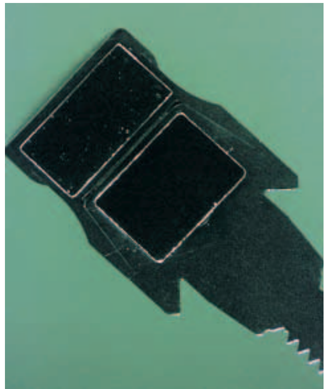
Abb. 4 Der Querschliff durch Matrize und Patrize zeigt die gute Passgenauigkeit des Verankerungselementes, beide Magnete sind deutlich umschlossen.
