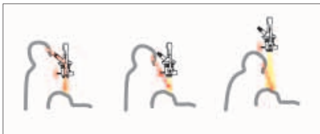
Abb. 8 Durch Anheben kann das OPM als temporäre OP-Lampe dienen. Lichtkegel wird grösser und weniger hell.
