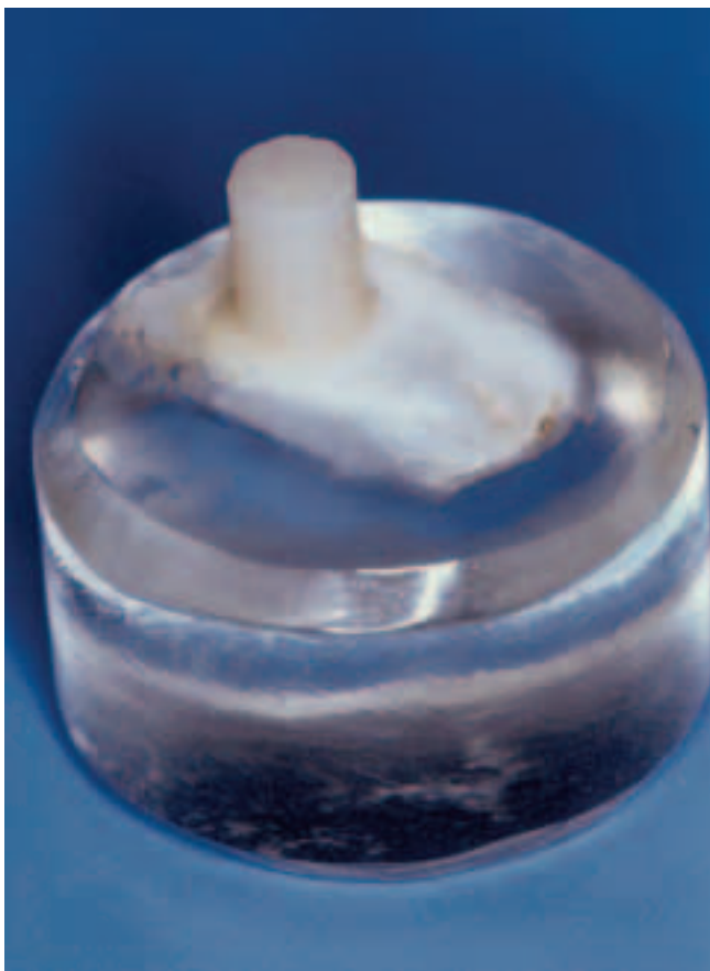
Abb. 4 In Epoxy eingebettete und feingeschliffene Dentinprobe mit aufgeklebtem Kompositzylinder
