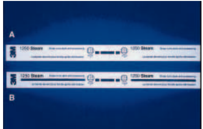
Abb. 10 Multiparameter-Indikator (3M™, Comply™, 1250): die vor dem Autoklavieren hellgelbe Farbe auf dem Indikator-Pappstreifen (A) verändert sich während des Autoklavierens auf der ganzen Länge des Streifen über braun nach schwarz. Wenn die Farbe des Indicators von dem auf der Mitte aufgedruckten Referenz-Farbaufdruck nicht unterschieden werden kann (B), war der Sterilisationsprozess einwandfrei.
