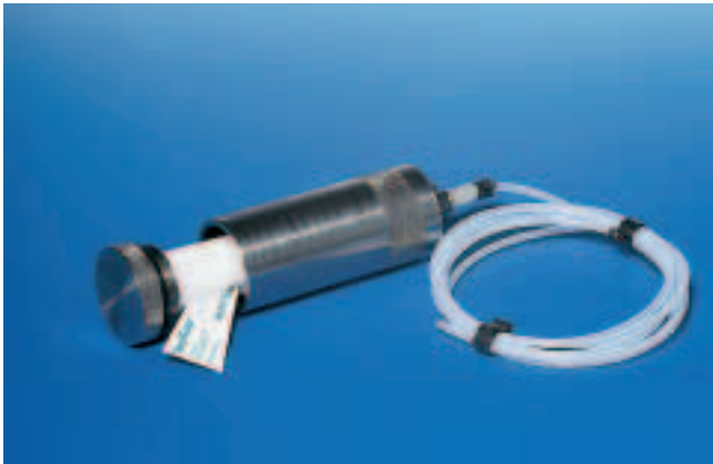
Abb. 9 Chargenkontrollkörper (3M™, PCD 01) mit Comply™, SteriGage versehen, wird eingesetzt, um die Wirkung des Sterilisationsprozesses in Hohlkörpern mit engen Lumina zu kontrollieren. Nach dem Einschrauben des Indikatorträgers kann der Dampf während des Autoklavierens nur durch den 2 m langen, mit einem Durchmesser von 1,5 mm versehenen Kunststoffschlauch den Indikator erreichen. Dazu ist ein Autoklav mit fraktioniertem Vorvakuum nötig. Das Bestehen dieses Härte-tests bietet Garantie für zuverlässige Sterilisation von Übertragungsinstrumenten.
