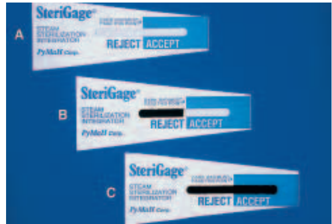
Abb. 8 Integrierender Multiparameter Chemo-Indikator (3M™, Comply™, SteriGage), der auf Zeit, Temperatur und Anwesenheit von Dampf anspricht; A: Noch unbenutzter Indikator; B, C: Autoklavierte Indikatoren. Beachten Sie, dass die schwarze Verfärbung in B knapp in der Zone «reject» stehen geblieben ist, der Sterilisationsprozess war ungenügend, während das schwarze Band in C weit in Zone «accept» gewandert ist, der Sterilisationsprozess war einwandfrei.
