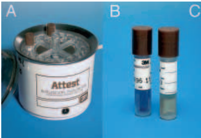
Abb. 7 Biologischer Indikator (3M™, Attest™); A: Inkubator; B, C: Bioindikator-Ampullen für evakuierende Autoklaven nach dem Autoklavieren. Beachten Sie, dass der Indikator in der Kulturflüssigkeit in Ampulle B unverändert violett erscheint und einen einwandfreien Ablauf des Sterilisationsprozesses bezeugt, während in Ampulle C Sporen überlebten, zu Bazillen auswuchsen und durch Säurebildung den Indikator nach gelb umschlagen liessen. Das Verfahren war ungenügend.
