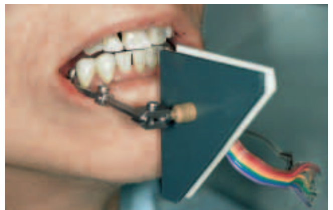
Abb. 4 Die Oberkanten der Dreiecksplatten sind parallel zur Kauebene ausgerichtet, so dass auch die zwei hier lokalisierten Infrarot-Reflexlichtschranken entsprechend ausgerichtet sind. Der dritte Sensor ist in der unteren Ecke einer der Dreiecksplatten befestigt.
