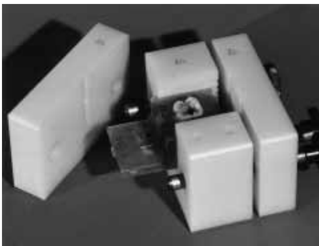
Abb. 1 Dreiteiliger Muffelblock zur Aufnahme des in Kunststoff eingebetteten Zahnes. Die drei Teile des Blocks sind verschraubbar, die Seitenwände können zur Entnahme des Zahnes und zur Anfertigung von Röntgenaufnahmen abgenommen werden. Der horizontal in vier Segmente aufgesägte Zahn kann über Führungsrillen reproduzierbar remontriert werden.
