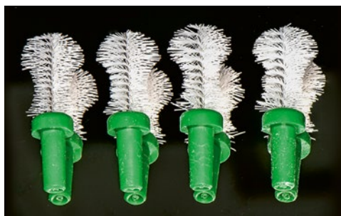
Fig. 2 Brosses tests (prototypes) avec 200, 250, 300 ou 350 filaments
