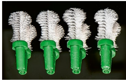
Abb. 2 Testbürsten (Prototypen) mit 200, 250, 300 oder 350 Filamenten
