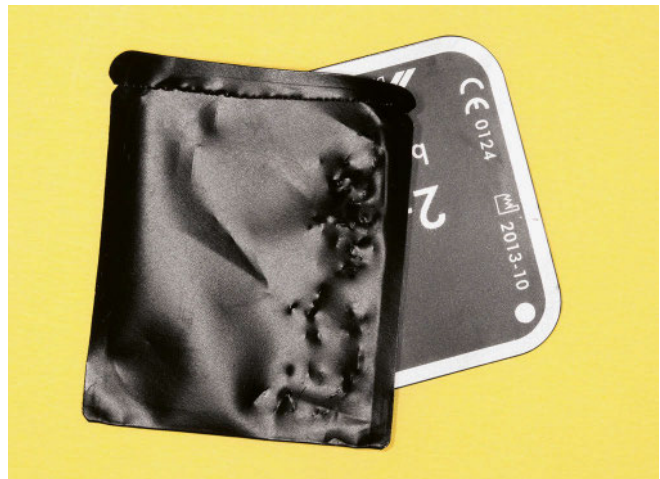
Abb. 7 Bissspuren auf der Schutzhülle der Speicherfolie
